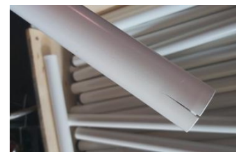
Фиг.11. Спукан заваръчен шев
