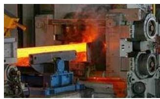
Фиг. 2 Горещо валцуване [4]
