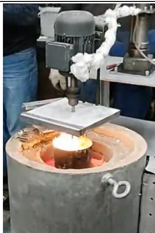
Фиг. 2. Хомогенизация на TiH 2 в съпротивителна пещ.
