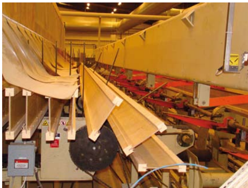
Belki typu I-beams na linii produkcyjnej zakładu Masonite Beams w Rundvik.
