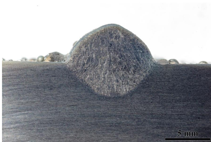
Rys. 74. Przekrój napoiny SW3.2 próbnej wykonanej metodą LKS, q_l = 1,07 kJ/mm
