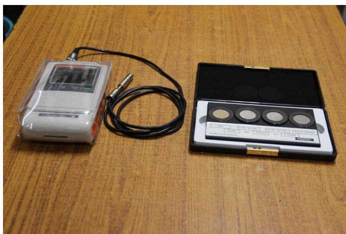
Rys. 53. Widok przenośnego ferrytoskopu Fisher MP30
