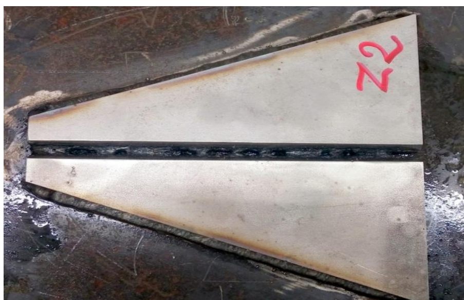
Rys. 117. Widok spoiny próbnej w próbce o zmieniającej się sztywności 1ZBM wykonanej w wodzie morskiej
