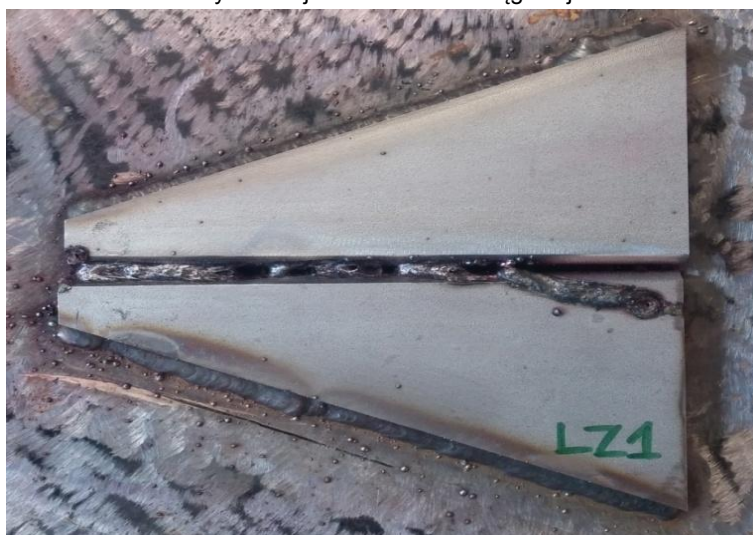
Rys. 119. Widok spoiny próbnej w próbce o zmieniającej się sztywności 1 ZLM wykonanej w wodzie morskiej
