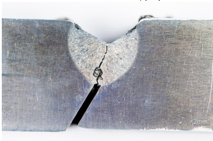
Rys. 107. Próбка Tekken 2TBS-2 - przekrój spoiny próbnej wykonanej w wodzie wodociągowej elektrodami BÖHLER. Pęknięcie w metalu spoiny inicjujące od strony grani
