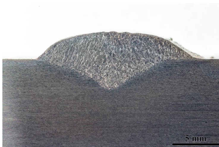
Rys.78. Przekrój napoiny próbnej SP9.2 wykonanej na powietrzu, q_l = 1,34 kJ/mm
