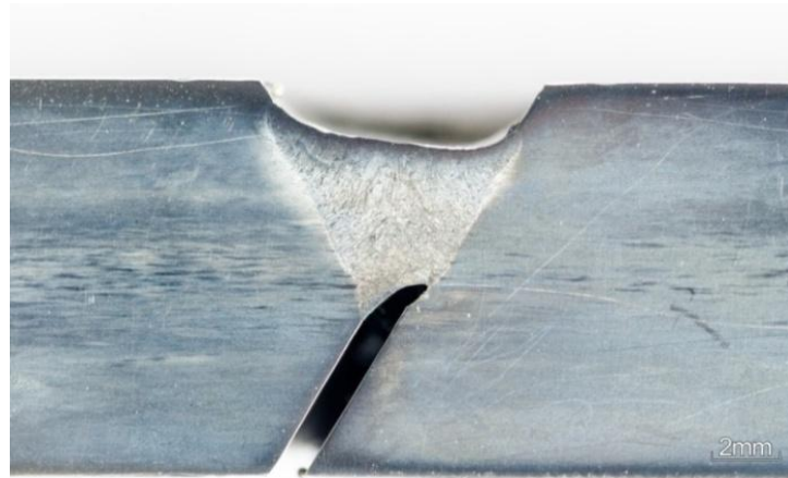
Rys. 110. Próbką Tekken 1TBP-1. Przekrój spoiny próbnej wykonanej na powietrzu elektrodami BÖHLER. Brak pęknięć
