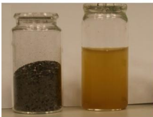
Płatki grafitowe (po lewej) oraz zawiesina tlenku grafenu (po prawej).
