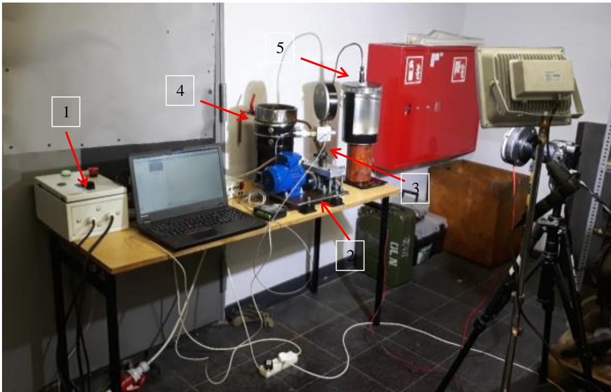
Rys. 3.1. Widok stanowiska do badania strugi rozpylanego paliwa. 1 – przemiennik częstotliwości (falownik), 2 – elektromechaniczny układ napędowy pompy wtryskowej, 3 – pompa wtryskowa z armaturą i przetwornikami ciśnienia, 4 – zbiornik zapasowy paliwa z układem podgrzewania, 5 – wtryskiwacz umieszczony na zbiorniku pomiarowym, 6 – układ rejestracji fotograficznej (źródło światła LED + aparat Sony RX 10III.)
