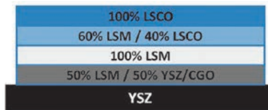
Rys. 1. Schemat półogniwa przedstawiający układ gradientowej katody na podłożu YSZ [25]
