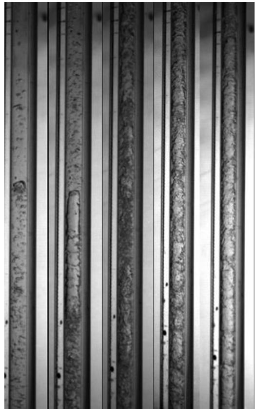
Rysunek 7: Struktury przepływu Pzr=0,6 G=265 kg/(m 2 *s) stopnie suchości kolejno: 19,6%, 27%, 35,2%, 55,6%
