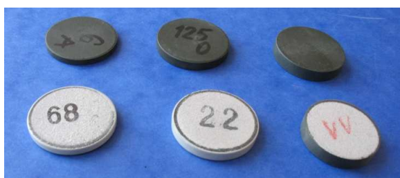
Rys. 1. Badane próbki warystorów po wypaleniu (w górnym rzędzie) i po naniesieniu powierzchni czołowych i bocznych (warystory po lewej stronie w dolnym rzędzie); w kolumnie lewej – próbki 280 V, środkowej – 440 V, po prawej - 660 V
