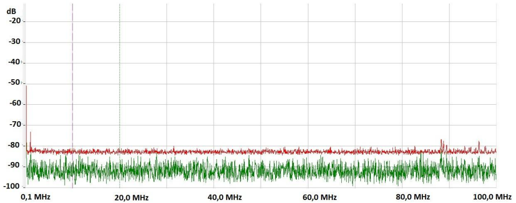
Rys. 4. Zarejestrowana składowa magnetyczna dla pasma 0,1 MHz - 100 MHz przy napięciu wyładowania ESD +1 kV
