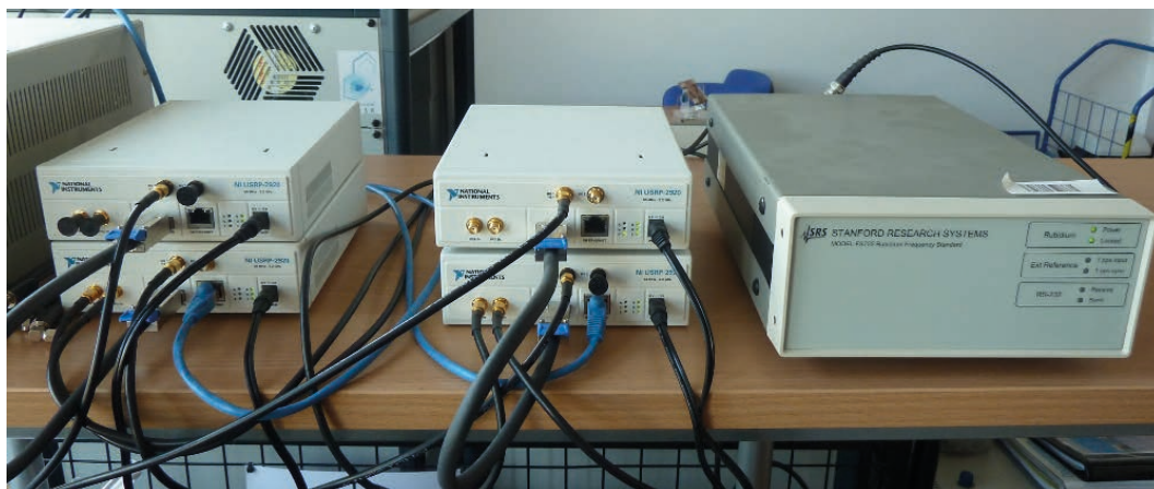
Rys. 4. Moduły radia programowalnego oraz rubidowy wzorzec częstotliwości
