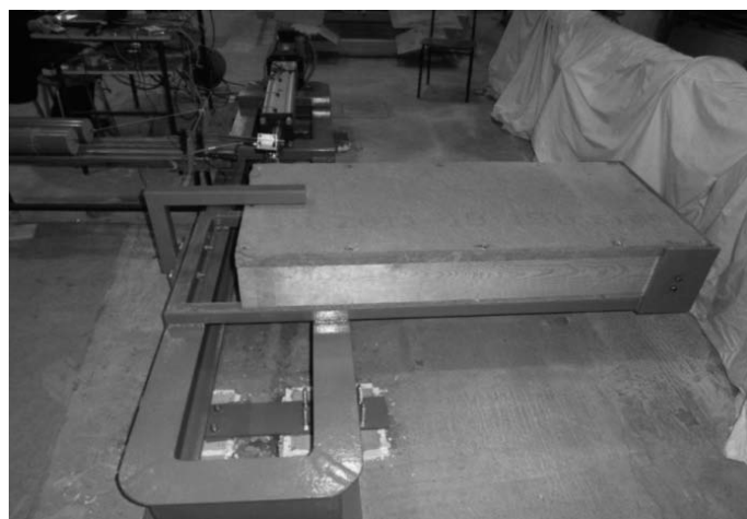
Rys. 1. Widok stanowiska badawczego z zamocowanym elementem ściennym
