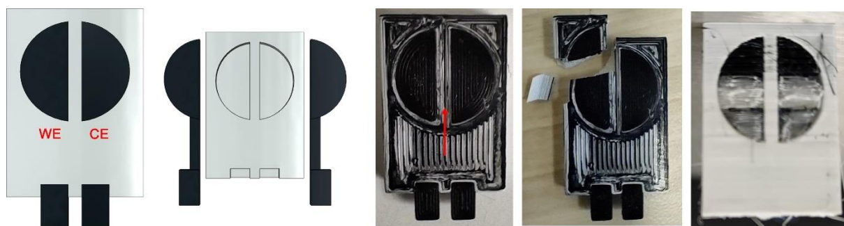
Rysunek 52. Układ dwóch niezależnych elektrod PLA/CB-PLA, drukowanych 3D, w których to jedna z elektrod jest elektrodą pracującą, druga przeciwelektrodą.
