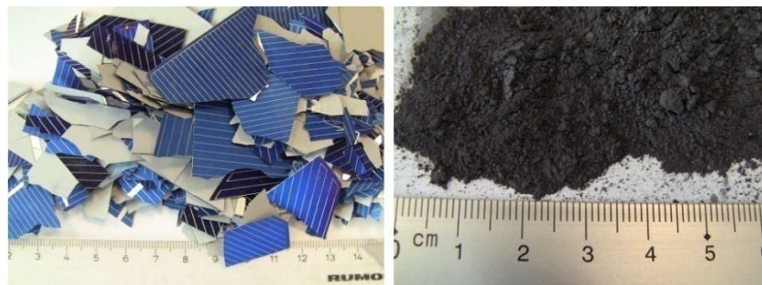
Rysunek 26 Próbki ogniów krzemowych zmielone w młynie firmy Retsch
