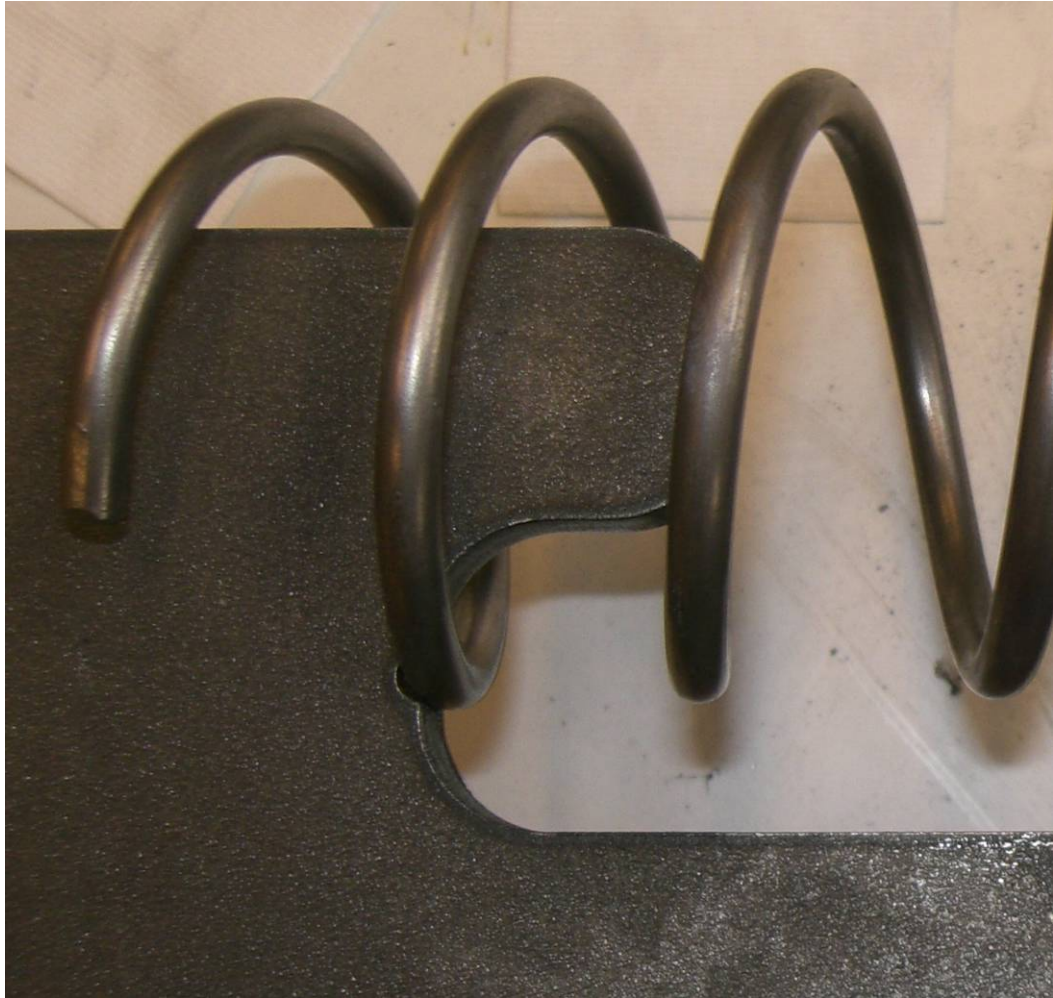
Bild 7: Fixierung der Wendelbewehrung an der Puzzleleiste
