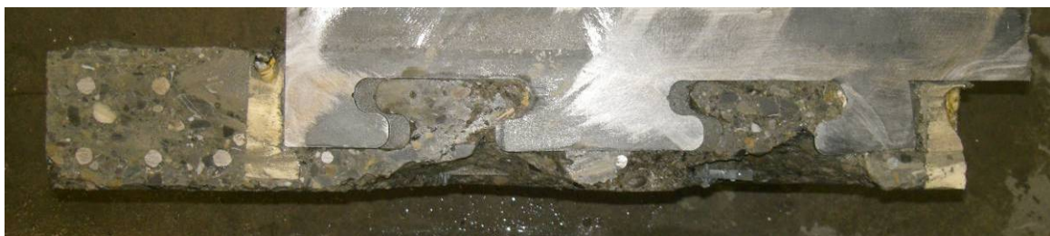
Bild 13: Prüfkörper Nr. 2 nach dem Zerlegen: unverformter Stahlsteg
