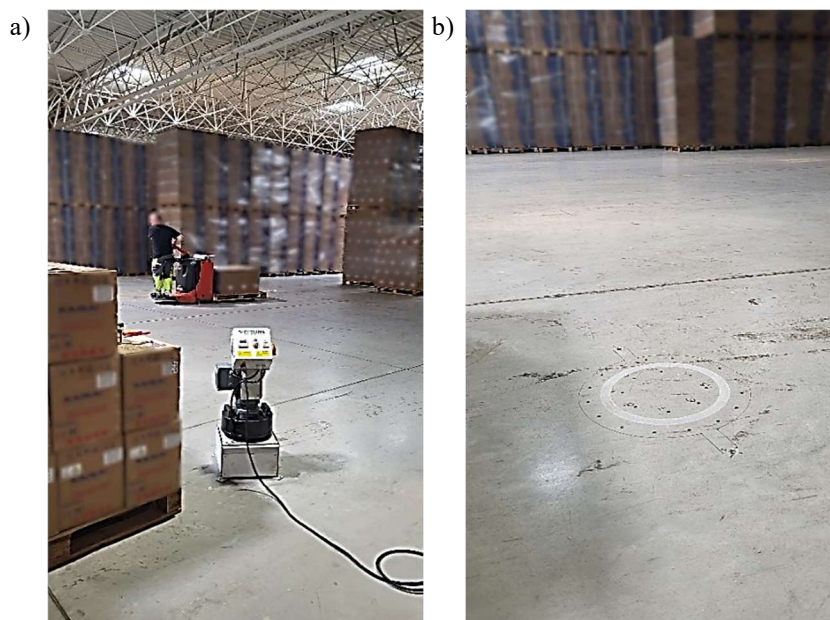
Rys. 11.2. Badania ścieralności metodą BCA: a) maszyna podczas badań, b) posadzka po zakończeniu pomiaru (fot. M. Niedostatkiwicz)
