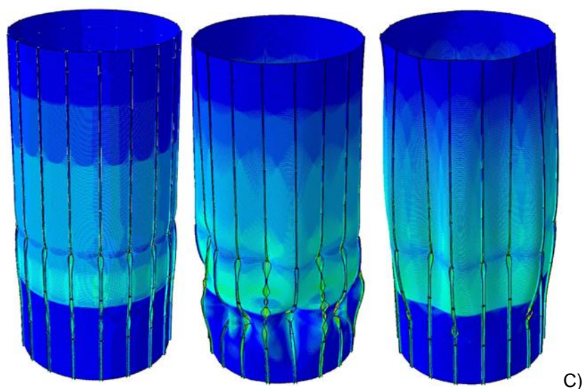
Rys. 4.12: Nieliniowe analizy dynamiczne MES (GNA) silosu z imperfekcją geometryczną w kształcie pierwszej postaci drgań własnych z rys. 4.8A dla czasu analizy t_a = 20s : A) współczynnik obciążenia \lambda w zależności od pionowego przemieszczenia górnej krawędzi silosu u dla amplitudy imperfekcji w : a) 0 mm, b) 25 mm i c) 75 mm, B) graniczny współczynnik obciążenia \lambda względem początkowej amplitudy imperfekcji w i C) deformacja silosu w stanie obciążenia granicznego (mapa naprężeń zredukowanych von-Misesa [MPa]; współczynnik skali deformacji równy 6) dla w : a) 0 mm, b) 25 mm i c) 75 mm.
