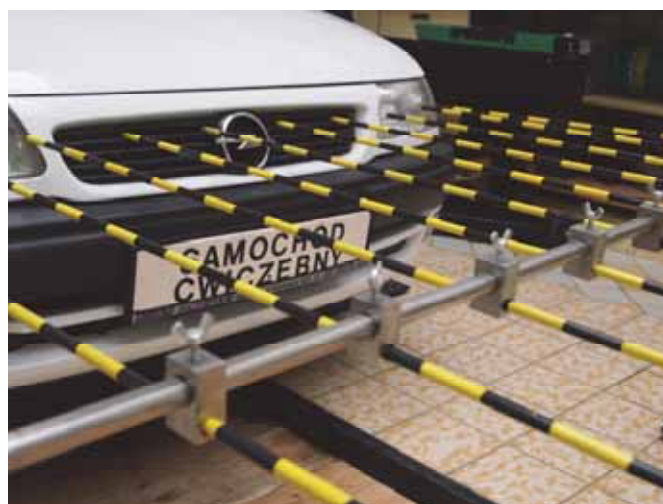
Rys. 4. Widok mocowania prętów pomiarowych do listwy poziomej
