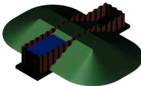
Rys. 2. Schemat stanowiska modelowego wału przeciwpowodziowego 11
