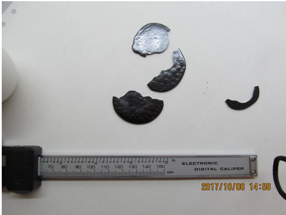
Rys. 16. Próbki wytworzone tradycyjną metodą wytopu.
