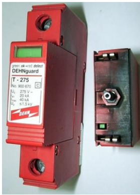
Rys. 1. Ogranicznik DEHNGuard (po prawej uszkodzona wkładka)
