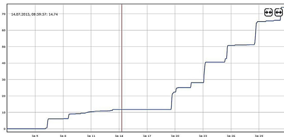
Rys. 7. Stacja Bystrzec-Reja – przykład pomiaru opadu przedstawiony w postaci krzywej sumowej [ http://anywhere.hydranet.pl/Obs/Gdansk/Melioracje ]
