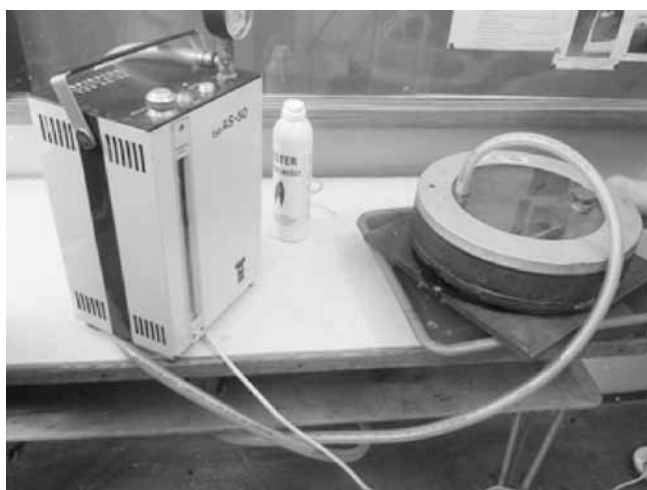
Rys. 5. Stanowisko do badania szczelności złączy spawanych przy zastosowaniu komory kołowej
