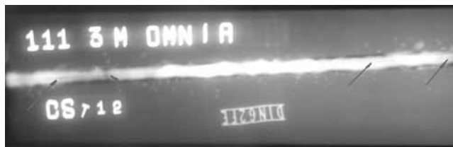
Rys. 7. Radiogram złącza spawanego 12/111/PA, widoczne niezgodności spawalnicze typu żuźle lub brak przetopu na całej długości próbki (wskazane strzałkami) [11]
