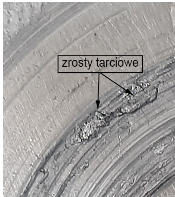
Rys. 8.23: Zrosty tarciove na powierzchni ciernej płytki zewnętrznej
