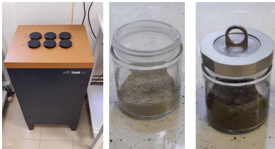
a) b) Rys. 1. (a) Kalorymetr izotermiczny; (b) Próbkę zaprawy w szklanych ampułkach.
