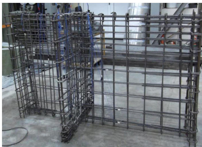
Rys. 4.6 Zbrojenie układu tarczowego DB I-0.5 .
