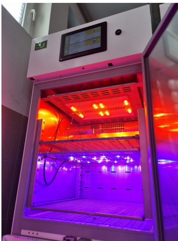
Rys. 17 Stanowiska fitotronowe, dwie niezależne półki fitotronowej z zamontowanymi dwoma modułami i ustawionymi dwoma różnymi widmami oświetlenia
