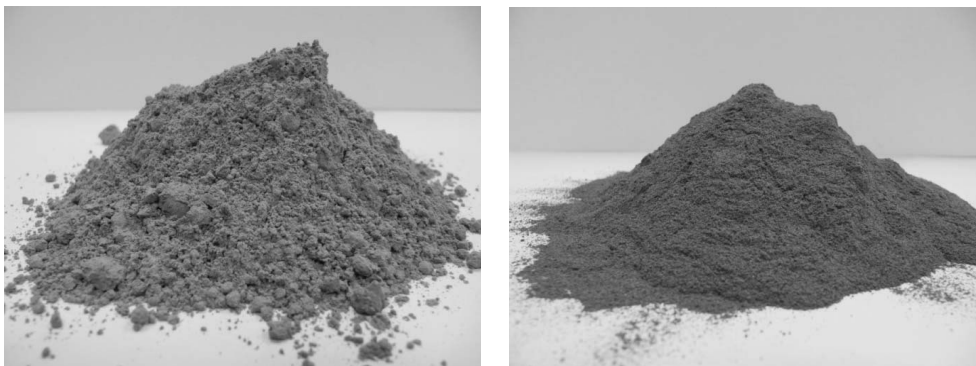
Rys. 1. Widok ogólny popiołu powstałego ze spalania węgla kamiennego a) bez biomasy b) z udziałem biomasy
