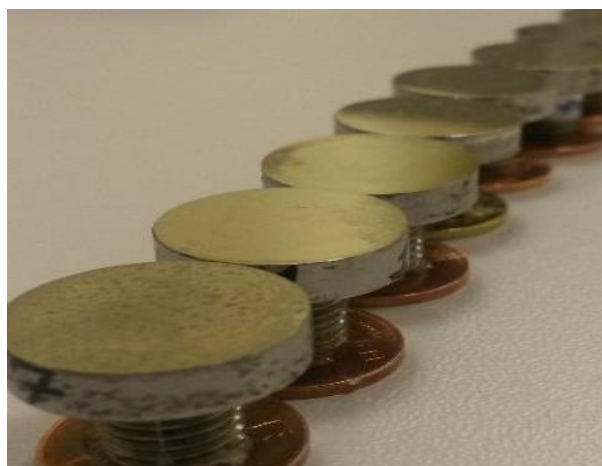
Rys. 50. Widok próbek służących do określenia rozkładu natężenia kawitacji.
