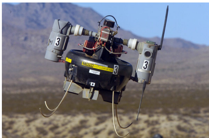
Fot. 2. Bezzałogowy aparat latający typu T-Hawk, wykorzystany do inspekcji reaktora Fukushima I (Honig, 2011)
