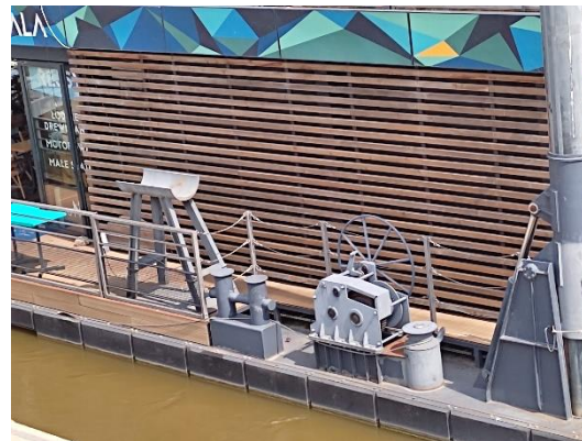
Rys. 3.68. Nowy system cumowania barki restauracyjnej, Bulwary Wiślane, Warszawa. (Miszewska, 2021)
