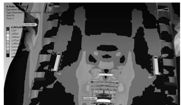
Rys. 12. Wyniki analizy: naprężenia zredukowane, obszary o największych wartościach naprężeń w skorupie fotelika [1]
