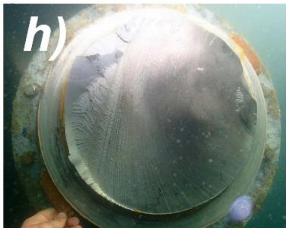
Rys. 1. Uszkodzenia zmęczeniowe wałów napędowych statków:
