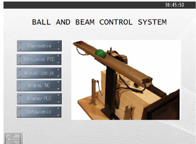
Rys. 7. Panel operatorski – główne okno
