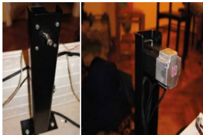
Rys. 3. Serwomotor zamontowany na ceowniku
