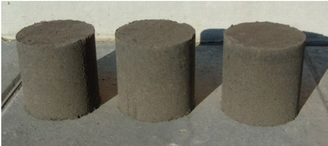
Zdjęcie 5. Próbkki mieszanki popiołowo-piaskowej stabilizowanej cementem
