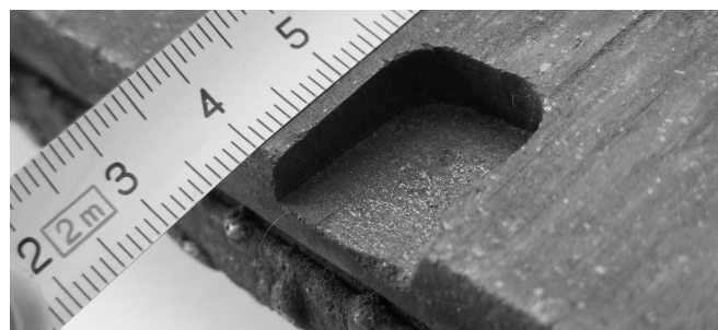
Rys. 9. Fotografia spreparowanego uszkodzenia nakładki stykowej
