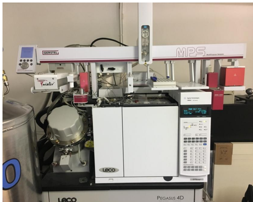
Rysunek 13 Widok ogólny zestawu GC×GC-TOF-MS firmy LECO
