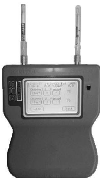
Rysunek 12 Widok ogólny urządzenia do pobierania próbek gazowych (Gerstel, Niemcy)
