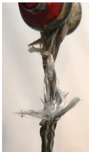
Rys. 11. Próbką po zerwaniu
