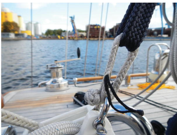
Rys. 6. Mięka szekla jako łącznik pomiędzy nokiem bomu a topenantą
