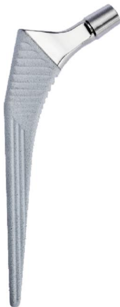
Rysunek 16. Trzpień endoprotezy stawu biodrowego ze stopu tytanu Ti-6Al-4V pokryty powłoką HAp [107]
