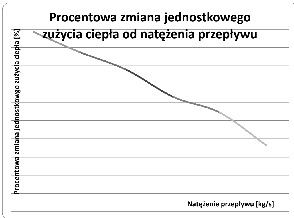
Rys. 7. Procentowa zmiana jednostkowego zużycia ciepła w funkcji strumienia masy pary świeżej
