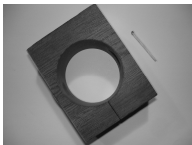
Rys. 9. Element zaciskający czujnik wykonany z tekstolitu (porównanie rozmiarów elementu z rozmiarem zapalki)
