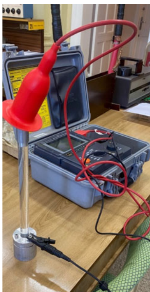
Rys.6. Wyznaczanie rezystywności słupa wody w rurce szklanej
