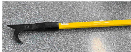
Rys.13. Narzędzia używane przez strażaków podczas akcji gaśniczej: a) Halligan, b) bosak
