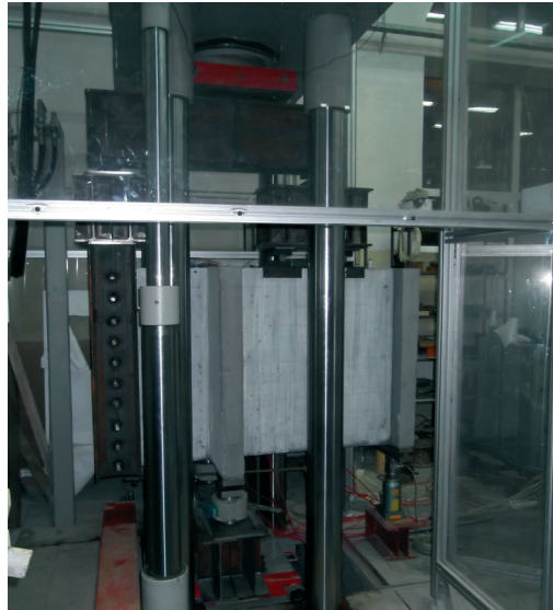
Rys. 5. Tarcza na stanowisku badawczym
