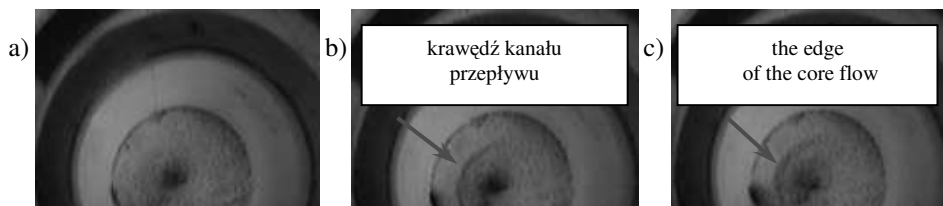
Rys. 6. Kształtowanie się kanału przepływu na wysokości 1,55 m dla pierścienia wewnętrznego 180/100/70 (mm) na wysokości 1,00 m od dna silosu w czasie: a) 6,08 s, b) 6,12 s oraz c) 6,16 s opróżniania silosu (piasek średnio zagęszczony, d_{50} = 1,0 mm, d_o = 0,07 m, ściana gładka)
