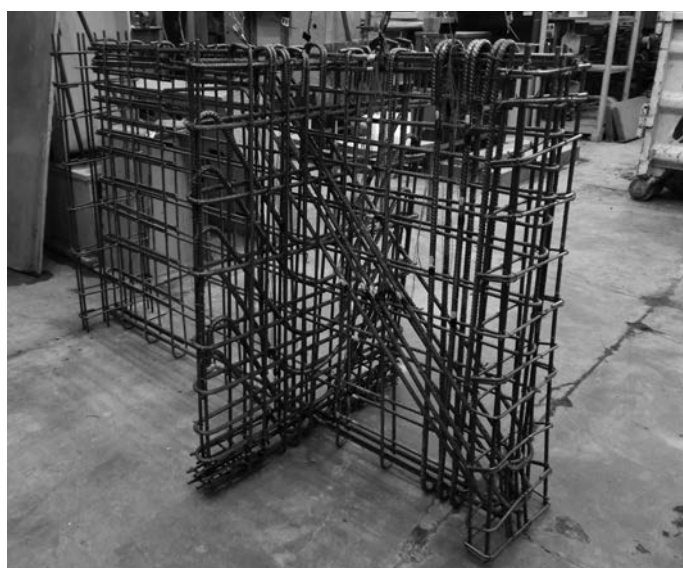
Rys. 4. Zbrojenie tarczy DB-II (z dodatkowym zbrojeniem ukośnym)
