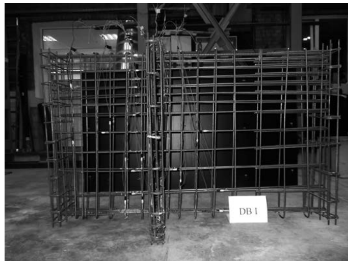
Rys. 3. Zbrojenie tarczy DB-I (zbrojonej ortogonalnie)
