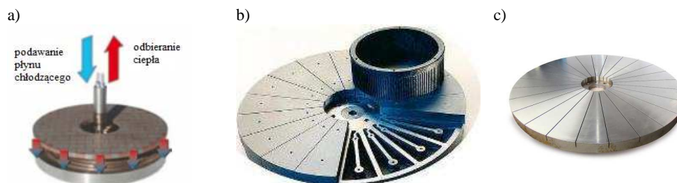
Rys.3. Budowa tarcz docierających: a) sposób chłodzenia, b) docierak chłodzony wodą firmy Peter Wolters, c) docierak rowkowany bez chłodzenia wewnętrznego firmy LAMPLAN [17]
