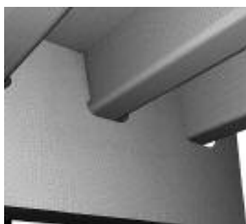
Rys. 5. Szczegółowy model MES pomostu ortotropowego
