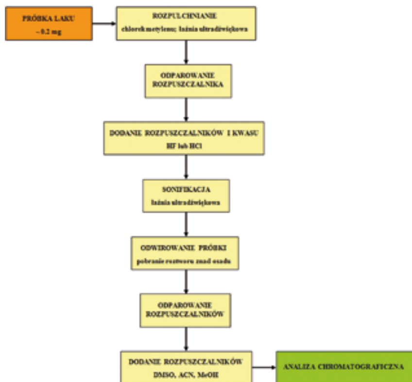
Rys. 2. Schemat ideowy kolejnych etapów ekstrakcji substancji barwiących ze spojwa malarzkiego
