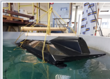
Stanowisko przygotowań pojazdu do badań oraz stanowisko pomiarowe do badań pola hydroakustycznego pojazdu AUV-S
