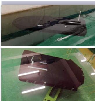
Przykłady elementów badań na modelu fizycznym pojazdu AUV-S, w tym: pojazd podczas testów hydrodynamicznych oraz badań pola hydroakustycznego dla różnych pokryć powierzchni kadłuba pojazdu
