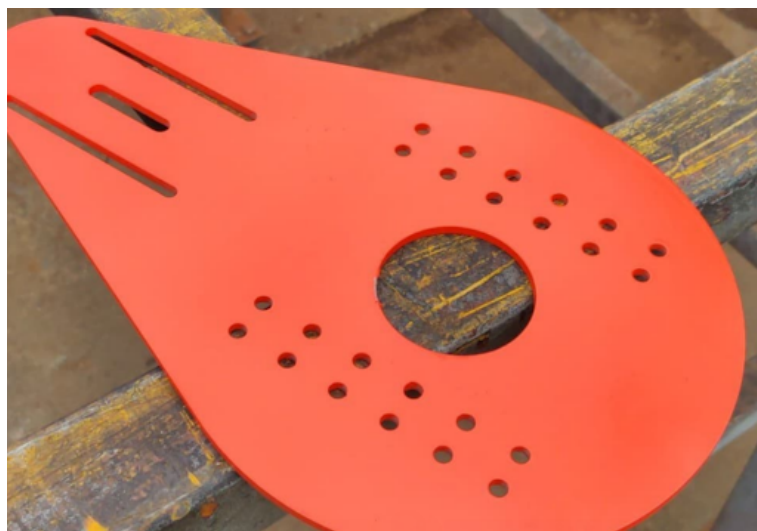
Rysunek 5.8. Element po wypiaskowaniu i pomalowaniu
