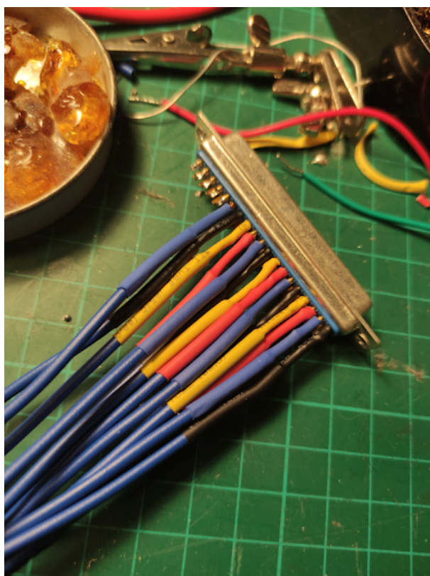
Rysunek 5.18. Lutowanie wtyczki DB-37
