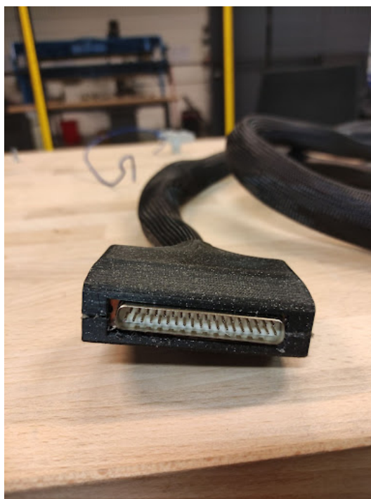
Rysunek 3.21. Wtyczka kabla łączącego robota z szafą sterowniczą
