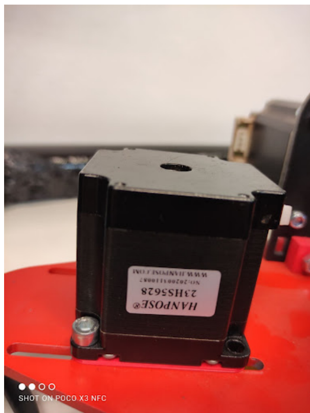
Rysunek 3.4. Silnik krokowy napędzający pas zębaty podstawy
