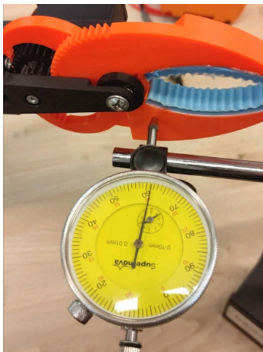
Rysunek 6.2. Pomiar czujnikiem zegarowym
