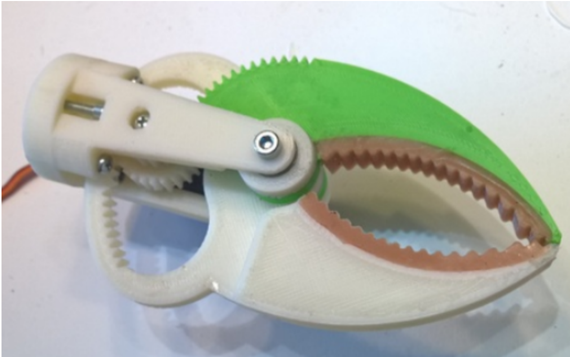
Rysunek 2.19. Wybrany mechanizm chwytający. Oryginalna nazwa : Mantis Gripper [13]
