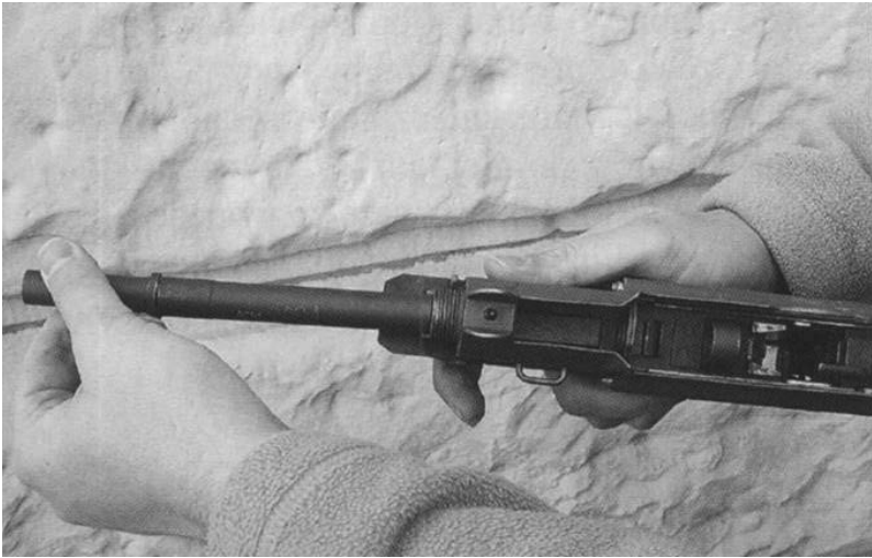
Rys. 15. Odkręcenie nakrętki mocującej lufę – należy wcisnąć zatrząsk nakrętki mocującej lufę i ją odkręcić
